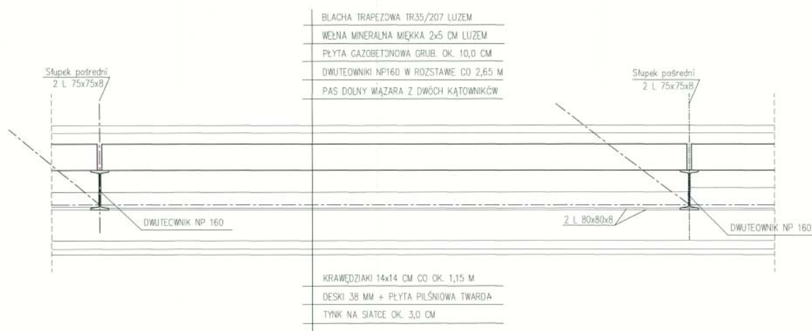
Rys. 4. Przekrój przez sufit podwieszony i strop nad Salą Koncertową (źródło: [15])
